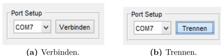
Abbildung 5.5: Verbinden und Trennen des virtuellen COM-Ports in der GUI.
