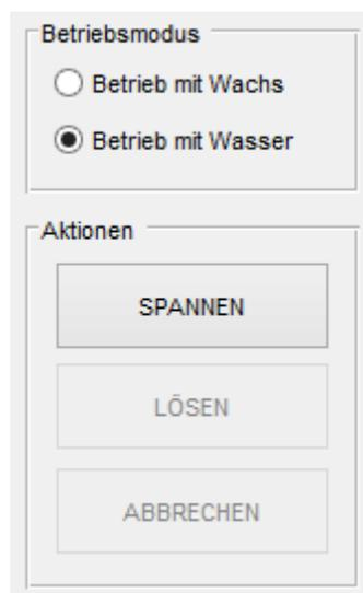
**Abbildung 5.6:** Buttons und Radio Boxes zur Steuerung des Spannsystems innerhalb der GUI.
